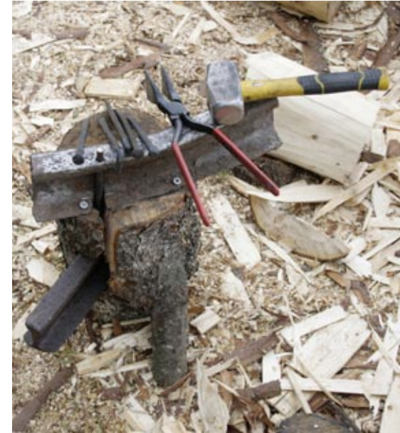
Lauri Saarinen valmisti puuttuvat takonaulat siihirsien kiinnittämistä varten.
