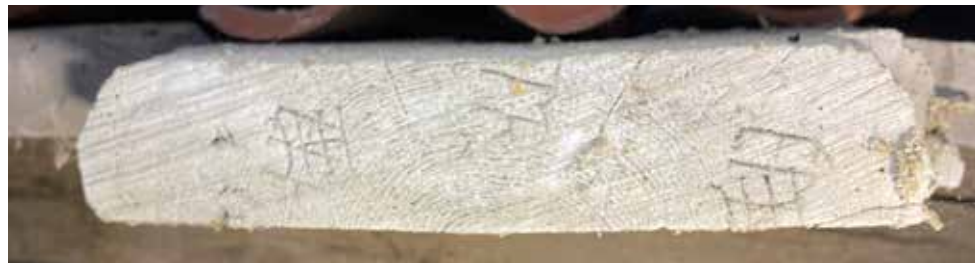
Puutavaraliikkeen leimakirveen lyömäjälkiä.
