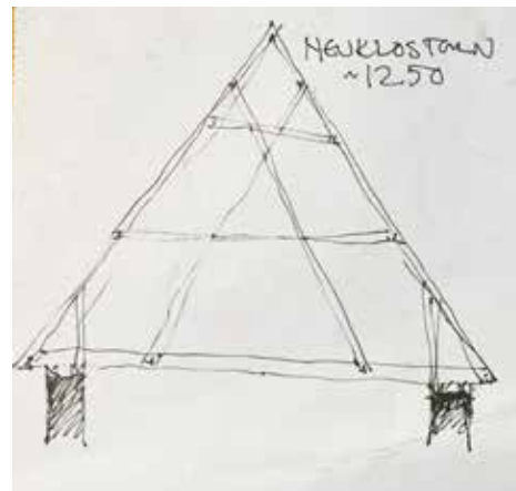
Runkokuoneen kattotuolin kaavio. Marko Huttunen.
