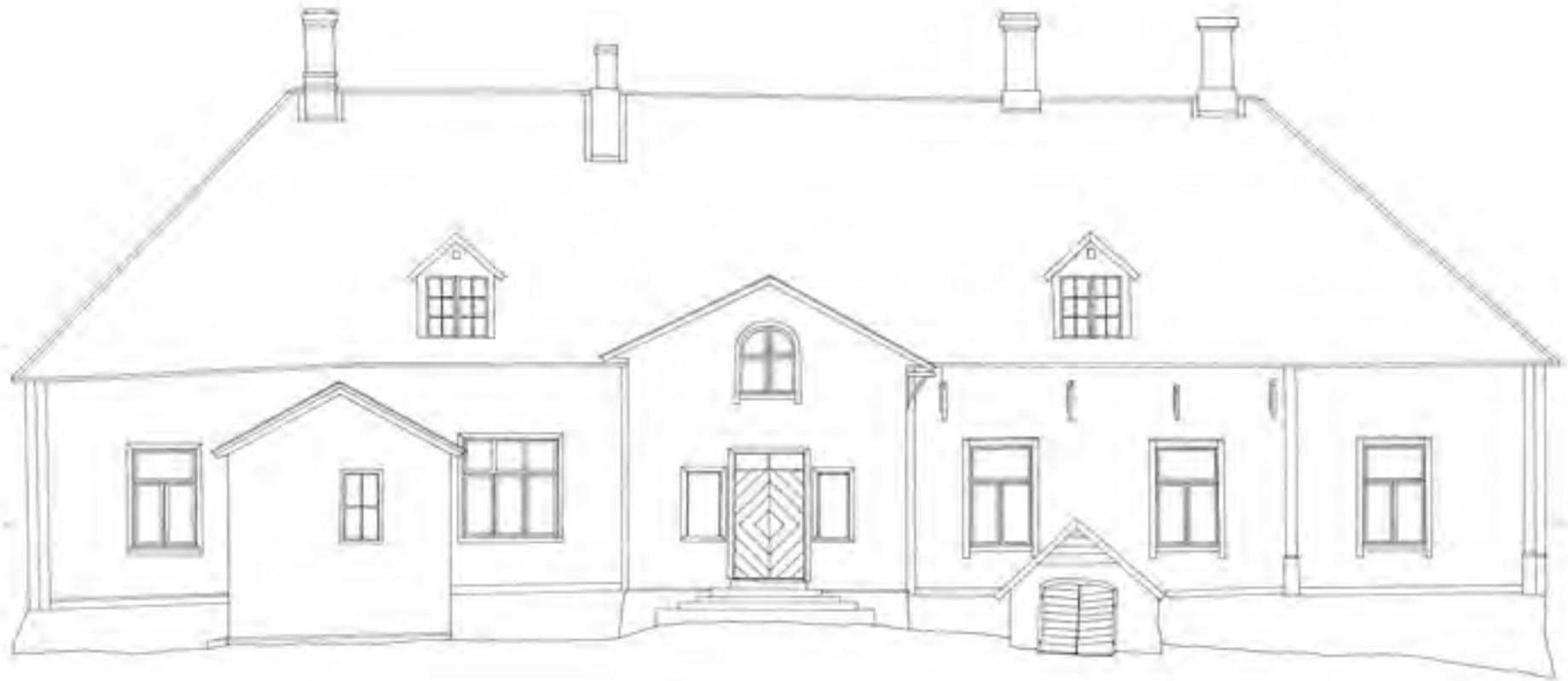
Kuusiston kartanon päärakennus, pääjulkisivun mittauspiirustus. T. Heininen & T. Hirvonen 1979 / MV RHO.
