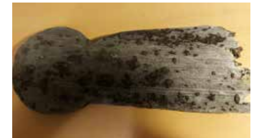
Talteen otettu murtuneen räystäspaanun pää.
