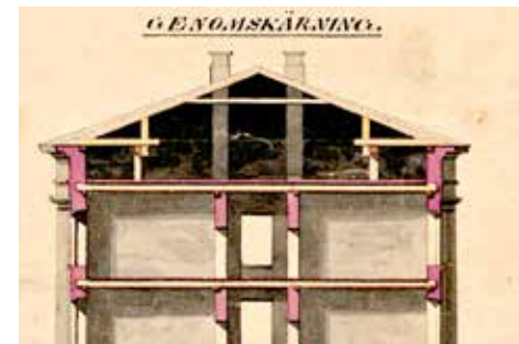
Upseerikasarmien leikkauspiirustuksessa (1833) Engel käyttää paikalliseen perinteeseen kuuluvia konttikattotuoleja. KA.
