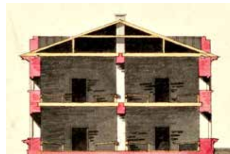
Engel laati vuonna 1820 Merikasarmin matruusikasarmista kenraalikuvernöörin pyynnöstä piirustuksen Viaporin insinöörikomennuskunnan käyttöön. Siinä esitetään toteutettu vesikattorakenne, joka vastaa keskieurooppalaisia ratkaisuja. KA.
