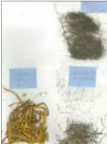
Lammasnavetassa ja sikolätissä savilaastin kuituna käytettiin olkea, kellarissa ja prännissä pellavan rohtimia ja päistäreitä. Pellavan toimitti Muuvgo Oy (Linenstories).
